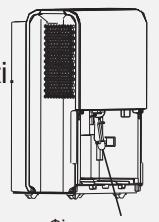
Обов'язково виливайте конденсат з ємності один раз на тиждень у разі використання функції дренажу. Якщо ви не користуєтесь функцією дренажу, від'єднайте шланг дренажного насоса від отвору для його підключення.
