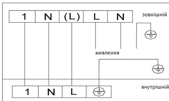
*Примітка:* для деяких моделей дроти були підключені до основної плати внутрішнього блоку виробником без клемної колодки.
